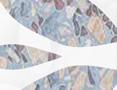
由染色砂与透明环氧树脂混合而成。创造出纯净的色块，或用以大色块拼色的装饰性耐磨地面。
